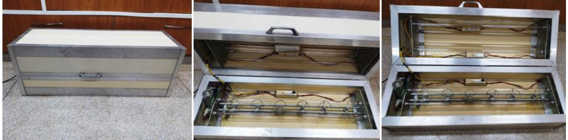
Figura 3 - Imagens fotografadas da caixa de madeira dotada das lâmpadas U.V.
